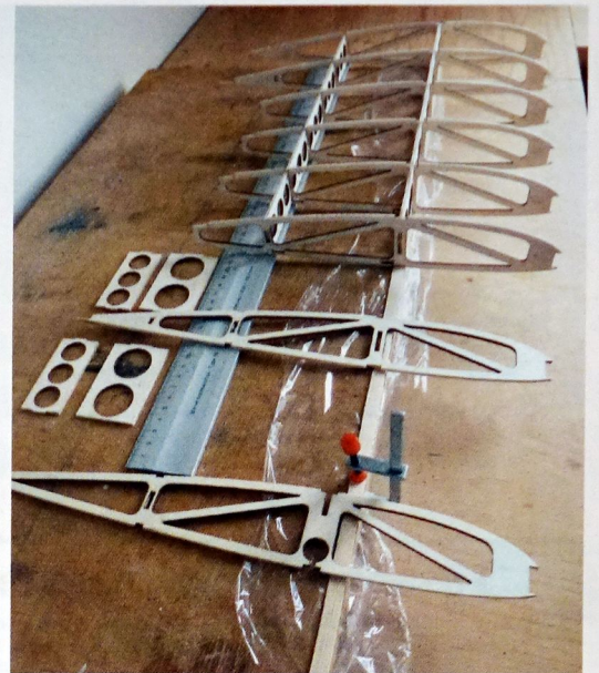
Die ersten Rippen werden auf den vorderen, unteren Holm geklebt, die Verkastung wird gleich mit eingeklebt. Gut zu sehen ist das Metalllineal als Auflage für die Rippen im hinteren Bereich
